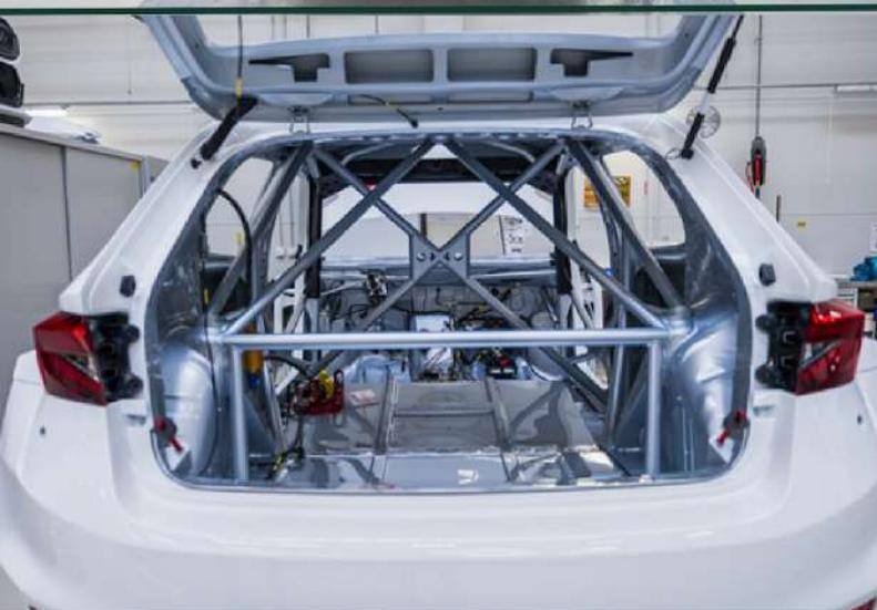
Básicamente, no hay diferencia entre la construcción de un auto de asfalto y un vehículo para tierra, solo algunas partes son diferentes, como amortiguadores, ruedas o muelles de suspensión. Los elementos opcionales tampoco complican ni alargan la construcción. Škoda Motorsport puede trabajar en tres a cinco coches a la vez, cada vehículo lo construyen siempre dos mecánicos. Cabe mencionar, que las labores más complejas son las de instalar la electrónica y el sistema de cableado.
